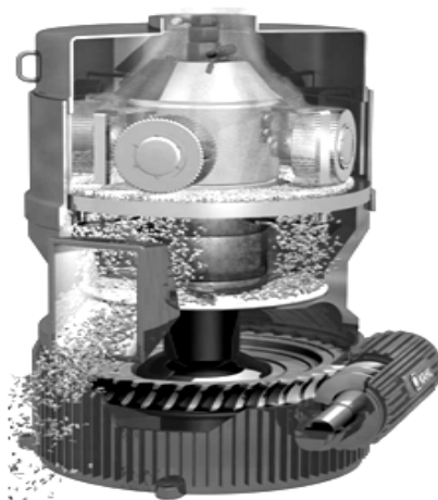
Fig. 1. Cross-section of flat die pellet press
